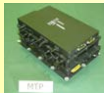
小型・軽量で高機能な送受信機(GCOM-C1,ALOS-2搭載)
