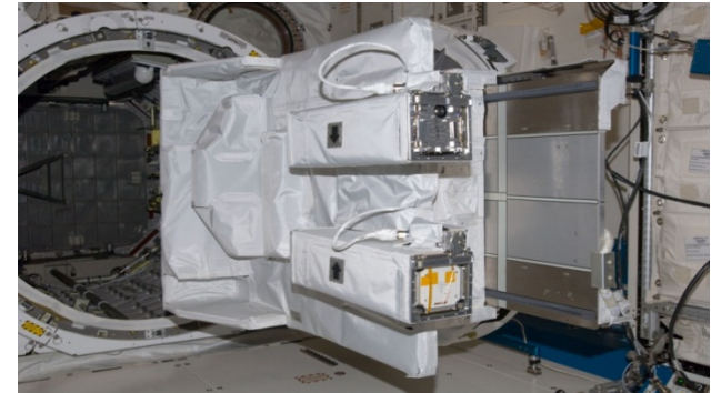
③ 軌道上で宇宙飛行士がバッグを開梱、衛星搭載ケースを含む放出機構をエアロックに取り付け
