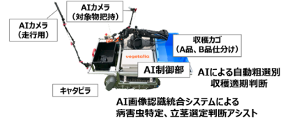
ブラシレスモーターロボットアームとキャタピラ ベジタリア (株) (アスパラガス自動収穫・運搬・粗選別ロボット)
