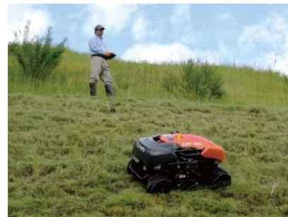
傾斜地の多い中山間地域におけるリモコン 草刈り機の導入（法面の緩傾斜化）
