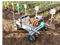
(株) Fieldworks (自律走行型除草・防除ロボット)
