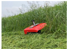
(株) ユニック (急傾斜対応型自動電動草刈りロボット)
