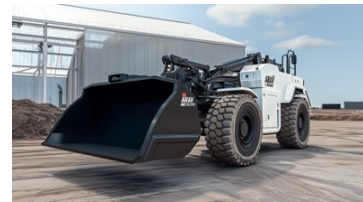
(株) ARAV (堆肥化ロボット (自律駆動ホイールローダー))
