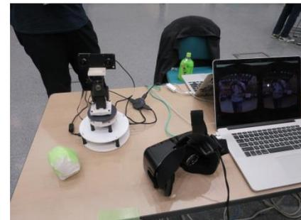
NTTコミュニケーションズ: WebRTCを用いてロボットを制御
